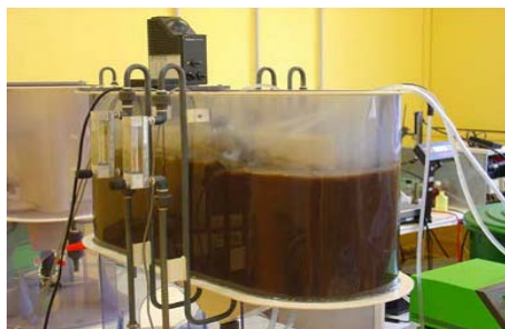
Couplage d'une séparation membranaire avec un procédé biologique pour le traitement d'effluents
