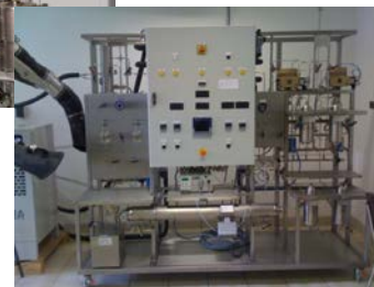
Réacteur enzymatique à membrane pour la synthèse d'arômes en conditions supercritiques
