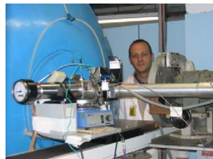
Dispositif pour une étude en milieu CO 2 supercritique
